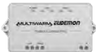
M-V-Gateway-Modbus Optional für alle Innengerätetypen (max. 16 Systeme oder 128 Innengeräten)
